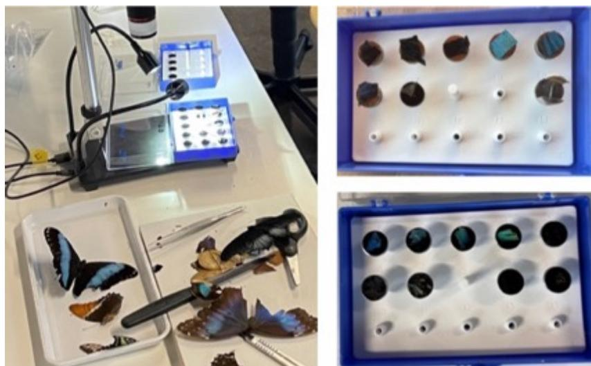
Abbildung 7: Vorbereiten der Schmetterlingsproben für das Besputtern (eigene Abbildung)
